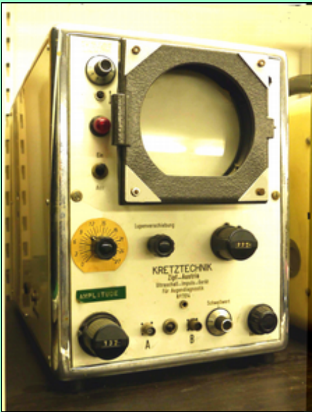
Abb. oben: Gerät Typ 7000.,Unten Umschalter von A-auf B-mode Zeile. Adapter für Bildschirmfotografie auf 35 mm-Negativ-Film
