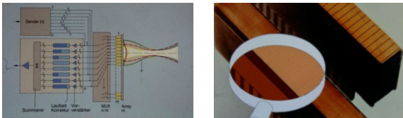
Abb. 1 Linear Array, a Prinzip der Abtastung und dynamischen Fokussierung, b Feinteilung
