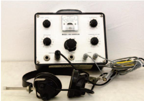
Abb. 3: Tragbares Dopplersonographiegerät Parks 802\* (USA). Entwicklung ab 1966, Produktion ab 1968. (© Ultraschallmuseum)
